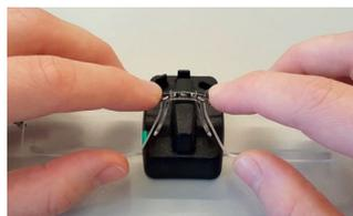
Posizionare il ponte con il fungo in verticale sul supporto di montaggio nel cuscinetto e premere fino a quando non scatta in posizione.
